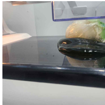
그림 18. 첫번째 프로토콜인 젤 패드와 젤 디스펜서를 사용한 Model 073 팬텀
