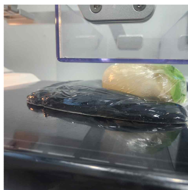
그림 20. 세번째 프로토콜인 젤 슬라임을 사용한 Model 073 팬텀
