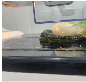
그림 18. 첫번째 프로토콜인 젤 패드와 젤 디스펜서를 사용한 Model 073 팬텀
