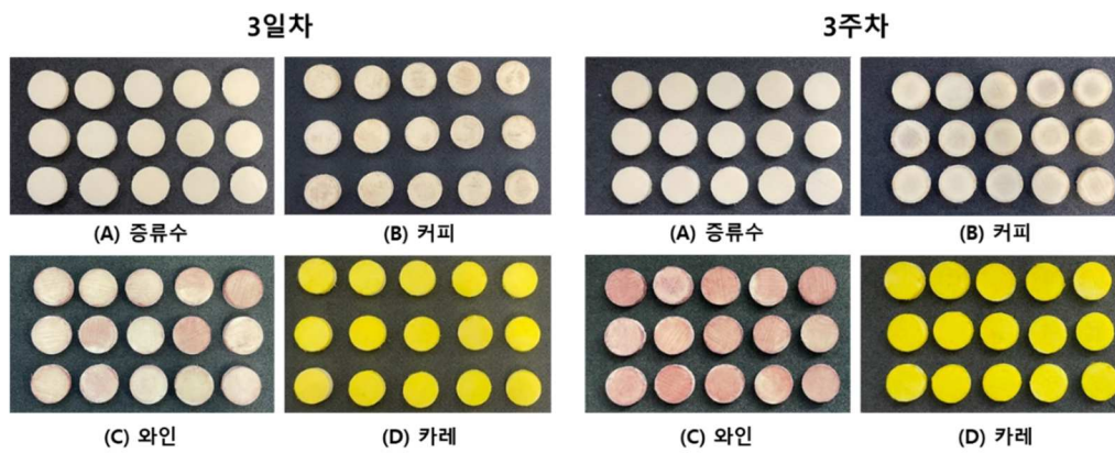
그림 10. PLA(QA2-4) coloring solution precipitation 3 days, 3 weeks discoloration comparison
