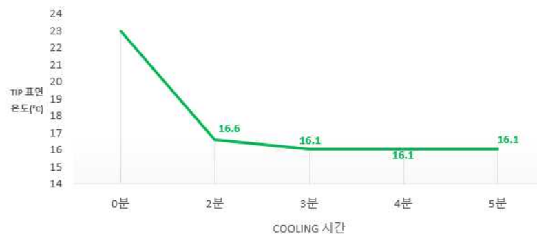
그림 8 쿨링 시간 경과에 따른 Sapphire Tip의 Sapphire glass 표면 냉각 온도
