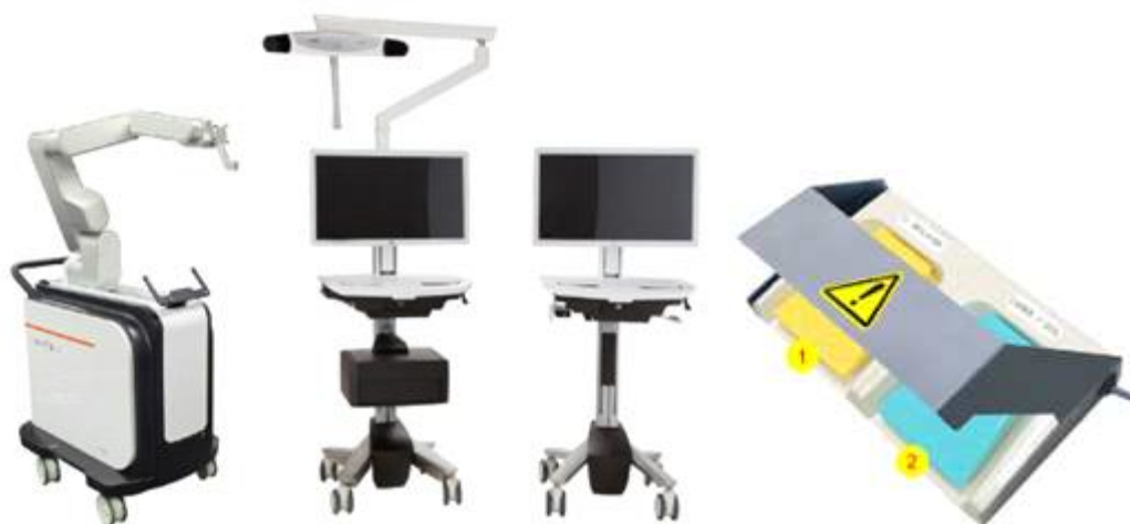
그림 1. Curexo spine, CS200의 구성. 왼쪽부터 Robotic arm, Main console, Staff console(optional), Foot switch
