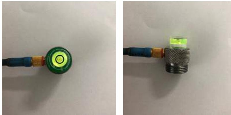
그림 22. 수평계 부착 후 A모드 초음파 측정
