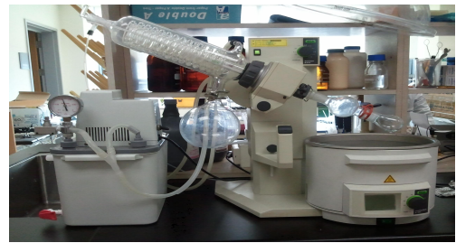
② Evaporator 장치를 이용한 농축
