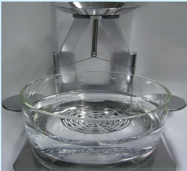
▶ 그림3. 분석저울을 이용한 밀도 측정.
