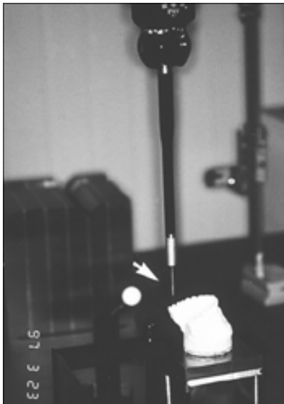
Fig. 3. 3차원 계측기로 석고 모형 기준점을 측정. 3차원 계측기를 이용하여 모형의 기준점에 대한 3차원 좌표값인 전후방 길이(X), 측방 길이(Y), 수직 높이(Z)를 측정하는 모습. (화살표 ; 3차원 계측기의 측정단)
