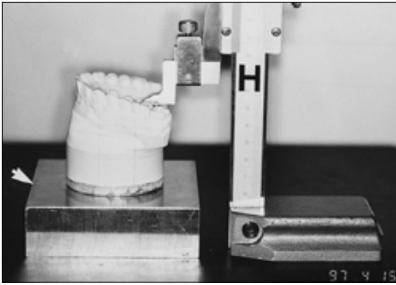
Fig. 1. 각 기준점에 대한 측정. 석정반상에서 model block에 올려진 석고모형의 기준점에 대하여 전후방 길이(X축), 측방 길이(Y축), 수직 높이(Z축)를 height gauge로 측정하는 모습. (화살표 ; model block, H ; height gauge)
