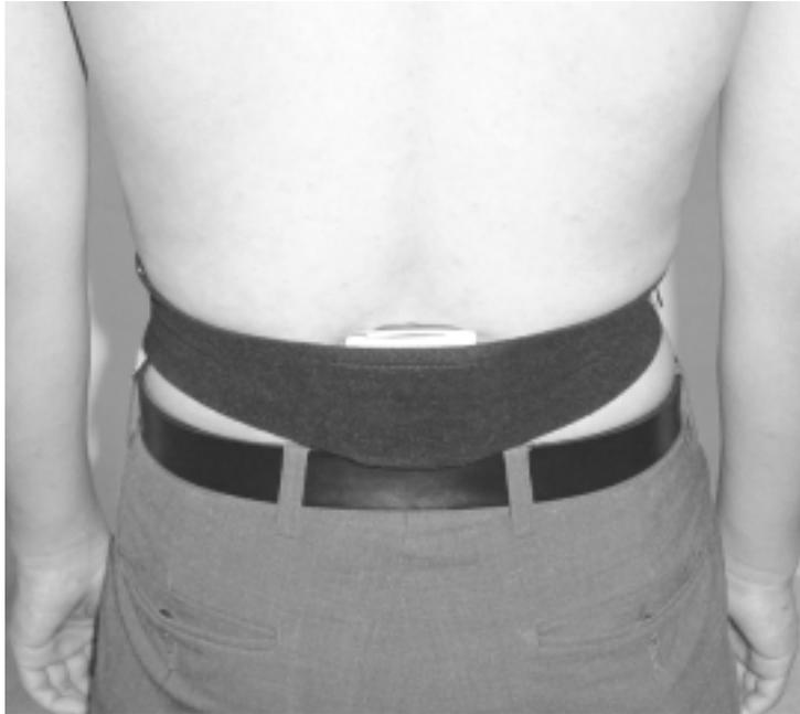
그림 15. 제작된 허리띠를 이용하여 가속도 모듈을 신체에 고정시킨 모습
