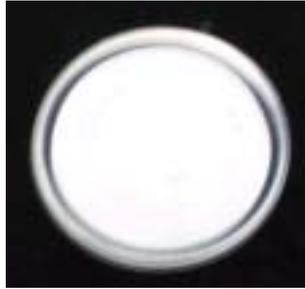
그림 5.12 동맥/정맥 챔버 수위 조절 시스템에 사용한 공기 필터
