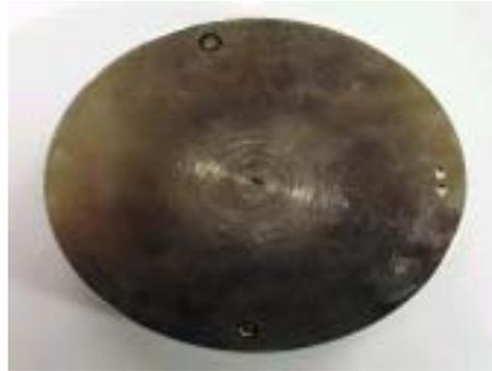
그림 4.20 Flow Equalizer에 사용된 금형 틀
