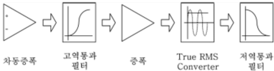
그림 3.9 임피던스 측정 전치부 개략도
