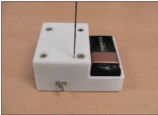
그림 8. 제작된 수신부 ( 좌:외부, 우:내부 )
