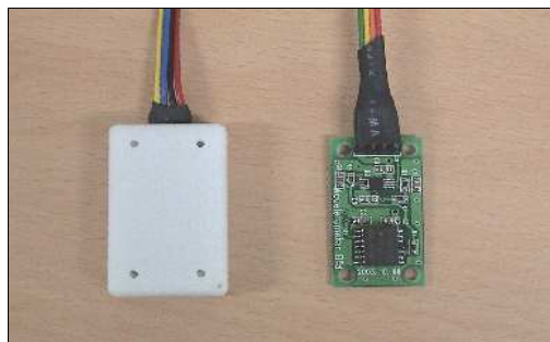
그림 4 제작된 가속도 센서부 ( 좌:센서의 외부, 우:센서의 내부 )
