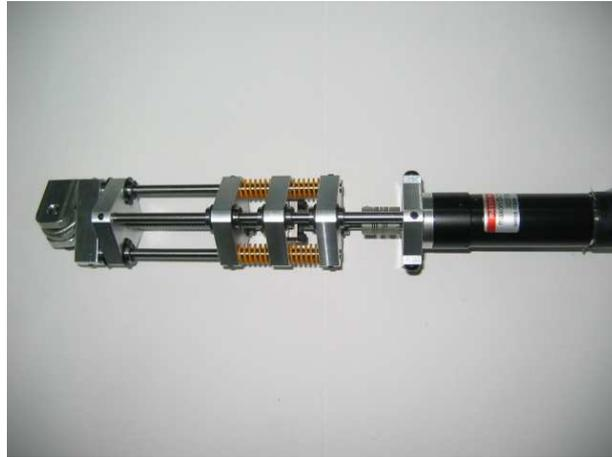
그림 3.6 제작된 구동부(Series Elastic Actuator)
