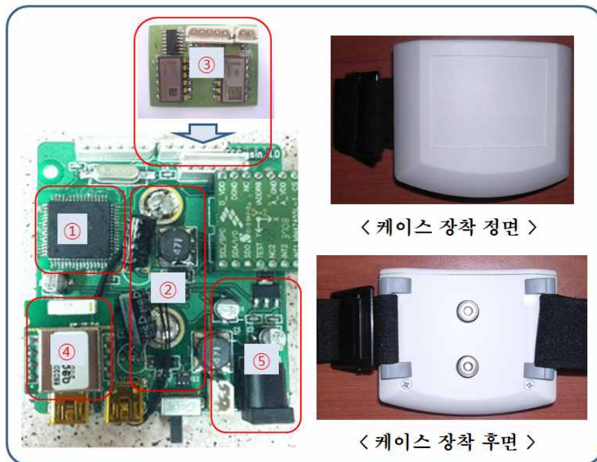
그림 5.3 제작된 FES 메인 시스템 보드 및 케이스 외관
