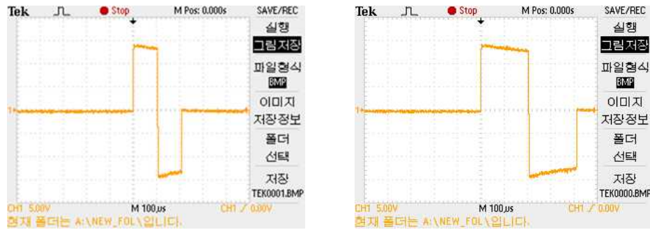
(a) (b) 그림 5.14 펄스 지속 시간을 변화시켰을 때의 결과 (a) 100 \mu s, (b) 200 \mu s
