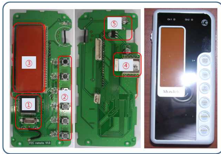
그림 5.5 리모트컨트롤 시스템 보드 및 케이스 외관
