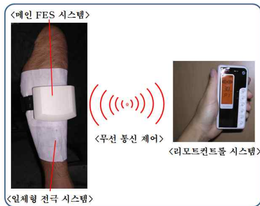
그림 5.11 구현된 보행보조 FES 시스템 적용 모식도
