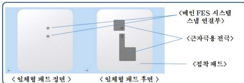
그림 5.6 일체형 전극 시스템 구성도
