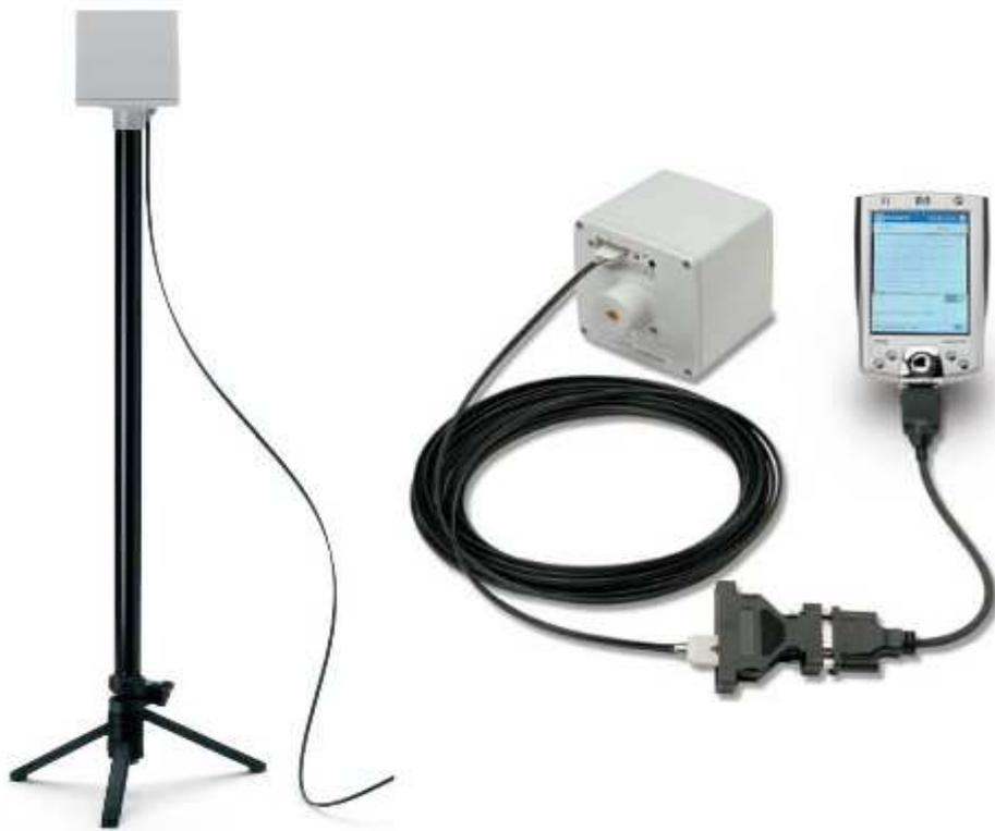
그림 4.1 EHP50C 측정 장비
