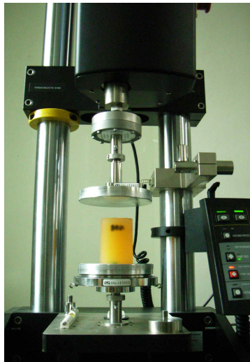
그림 4.17 Micro-Indenter를 이용한 팬텀의 탄성도 측정 실험
