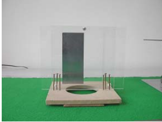
그림 2.7 ESF 곡선을 획득하기 위한 edge test pattern
