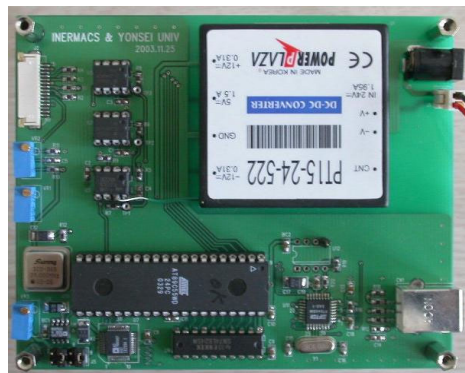
그림 4.9 RadEye1™ Imaging Sensor 제어용 prototype board
