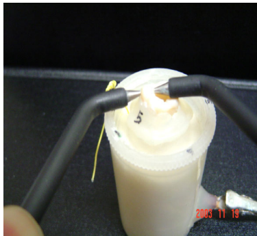
그림 38 치수 검사기의 전극을 이용한 임피던스 측정
