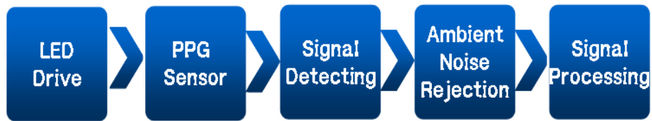
그림 3.6 PPG 신호 측정 구성도
