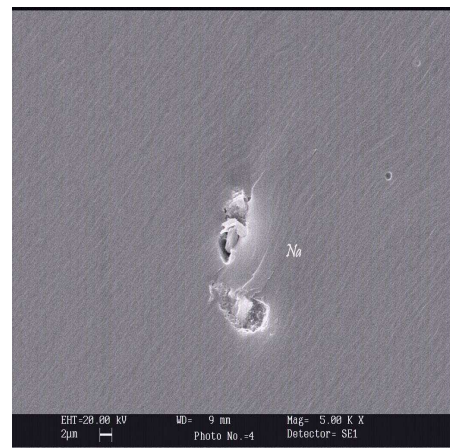
(d) NaF 2 % filled sealant( \times 5000 ).
