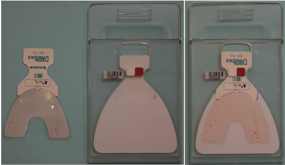
그림 5. 압력 감지 필름과 필름 카세트에 필름을 장착한 모습
