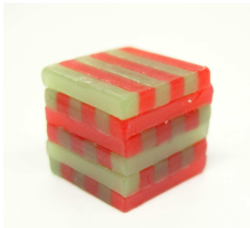
그림 1. 저작 효율 평가를 위해 사용된 왁스 시편 사진
