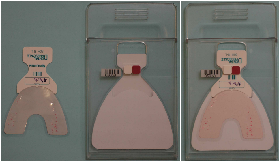
그림 2. 압력 감지 필름과 필름 카세트에 필름을 장착한 모습
