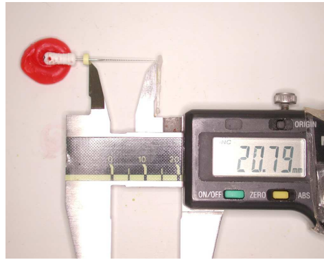
Fig. 2. Digital caliper를 사용한 길이 측정
