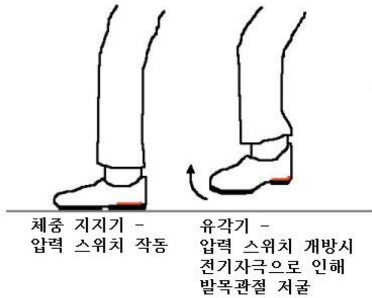
그림 1. 족하수 방지 기능적 전기자극기의 원리
